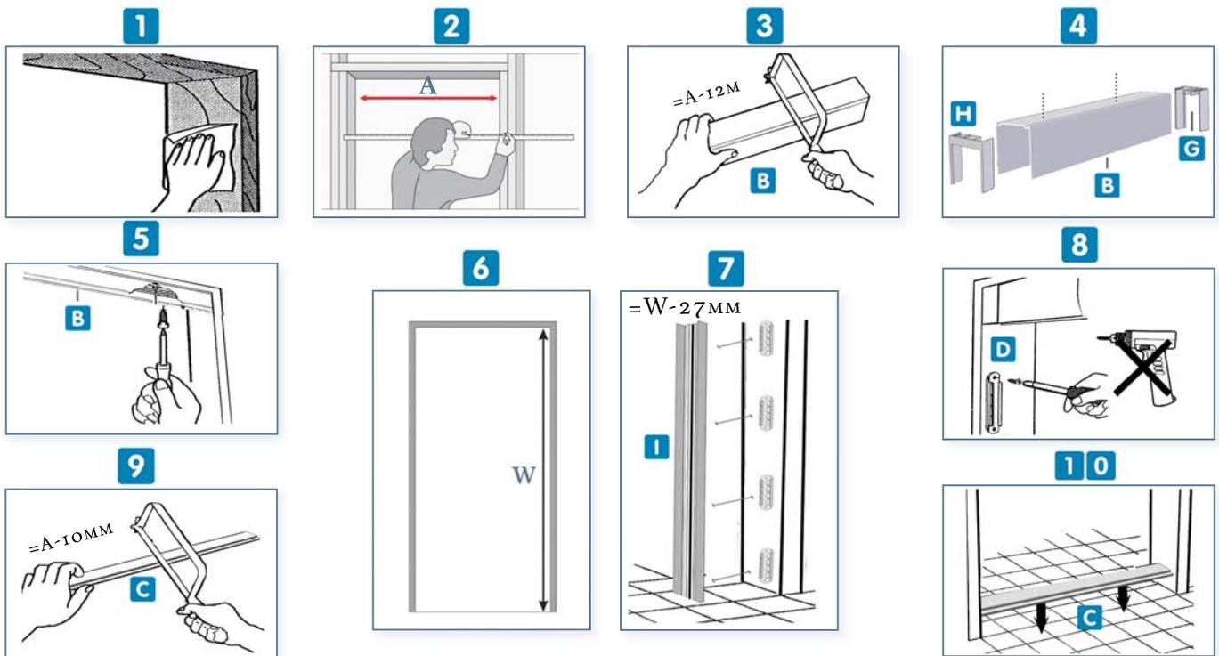
**ASEGÚRESE QUE EL HUECO ESTÉ NIVELADO. PROFUNDIDAD MÍNIMA DEL HUECO = 25 MM SE RECOMIENDA NO ABRIR LA MOSQUITERA HASTA HABER REALIZADO LOS 11 PASOS DE INSTALACIÓN. EL FLEJE DE LA MOSQUITERA HA DE QUEDAR EN LA PARTE SUPERIOR.**
