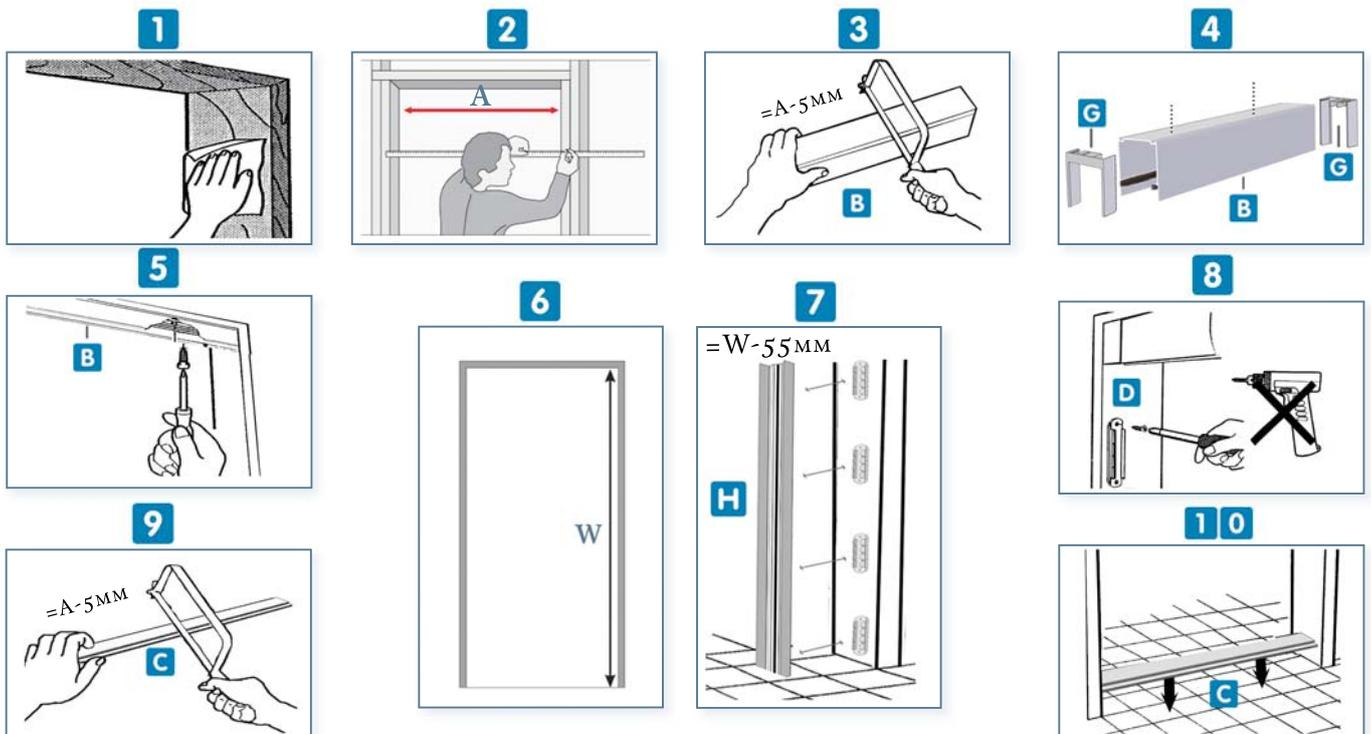
**ASEGÚRESE QUE EL HUECO ESTÉ NIVELADO. PROFUNDIDAD MÍNIMA DEL HUECO = 45 MM SE RECOMIENDA NO ABRIR LA MOSQUITERA HASTA HABER REALIZADO LOS 11 PASOS DE INSTALACIÓN. EL FLEJE DE LA MOSQUITERA HA DE QUEDAR EN LA PARTE SUPERIOR.**
