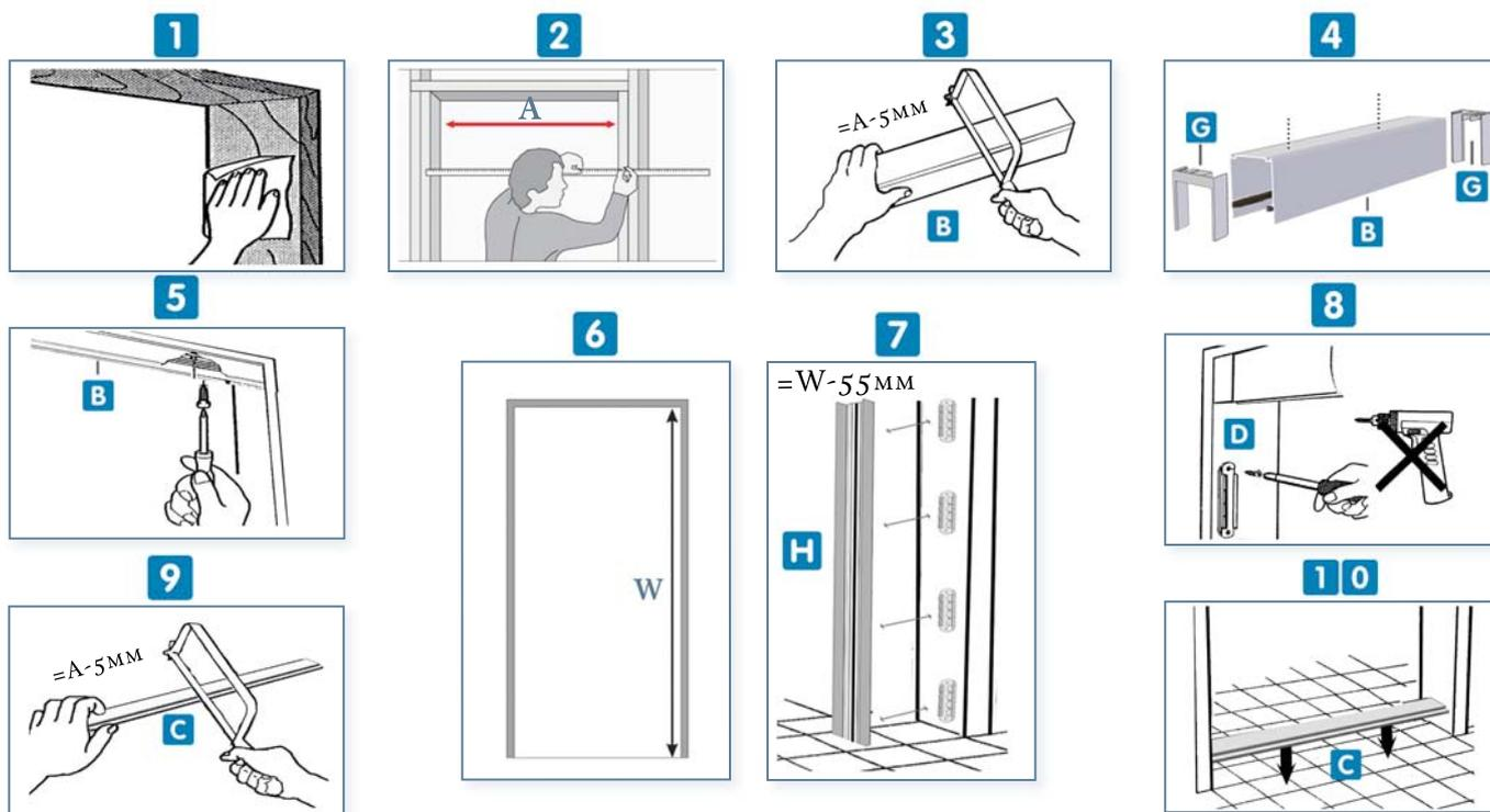
**ASEGÚRESE QUE EL HUECO ESTÉ NIVELADO. PROFUNDIDAD MÍNIMA DEL HUECO = 45 MM SE RECOMIENDO NO ABRIR LA MOSQUITERA HASTA HABER REALIZADO LOS 11 PASOS DE INSTALACIÓN. EL FLEJE DE LA MOSQUITERA HA DE QUEDAR EN LA PARTE SUPERIOR.**
